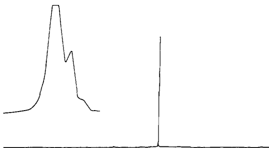
Fig. 16. 2 H NMR spectrum of acetone (CD 3 COCD 3 ).
